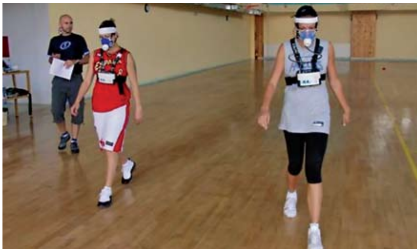
Slika 5: Merjenje plinov v izdihanem zraku z napravo K4B2 med vzdržljivostnim testom 30-15 (testiranje ženske reprezentance Srbije, Zlatibor, 2010)
